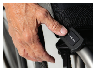
SwitchControl montat pe cadru
